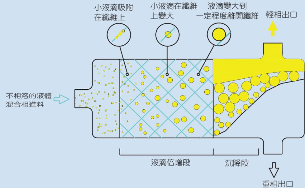
以液滴倍增技術為基礎下所開發的先進、穩定的倍增元件材料，提供更高分離效率的技術，在可吸附非均相氣-液與液-液中微小的分散相液滴方面，即使是只有幾um大小的液滴和高黏度的液體，只要兩種液體互不相溶，都可以透過小液滴之間的碰撞、倍增成較大的液滴，且在受到進料不穩定的因素影響較少下，進而實現非均相間的連續化地快速分離，其在設備運行成本低、佔地面積小以及能耗低下，同時實現節約能源與減少額外耗損。
